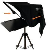
6. Tuch (4) über den Teleprompter legen, sodass freie Sicht auf das Reflexionsglas besteht. Das Tuch (4) mit den zwei Klammern (9) am Teleprompter befestigen.
