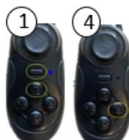
1. Start-Knopf drücken bis das Licht blickt. Gerät per Bluetooth mit der Fernbedienung verbinden. (Mocuto)
